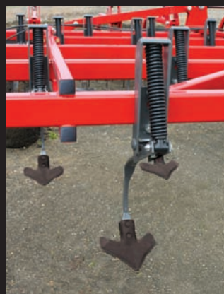
С-образная заостренная стойка с одной пружиной (усилие на отведение 91 кг) Только модели CH5731E
