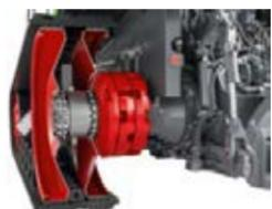
1427 кг: основной балластный груз + два дополнительных балластных груза на внутренней стороне
