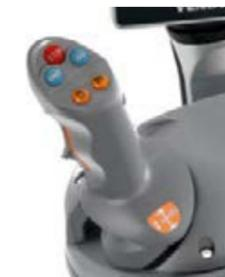
Джойстик предназначен для управления скоростью движения, режимами круиз-контроля, частотой вращения коленчатого вала двигателя и системой управления на разворотной полосе.
