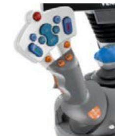
Оptionальный многофункциональный джойстик также включает кнопки для управления двумя гидравлическими клапанами.
