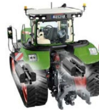
2 690 кг: 64 балластных груза на внутренней и внешней стороне рамы гусеничного модуля (32 груза на модуль)
