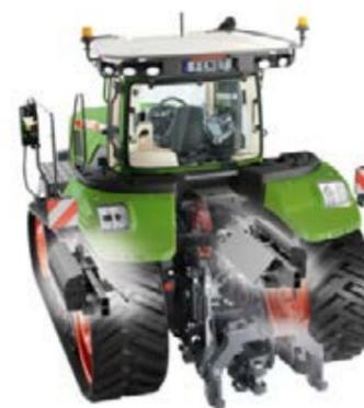
1 345 кг: 32 балластных груза на внешней стороне рамы гусеничных модулей (16 на один модуль); грязезащитный щиток на внутренней стороне
