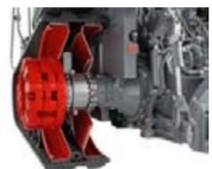
1427 кг: основной балластный груз + два дополнительных балластных груза на внешней стороне
