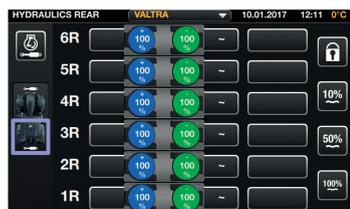
Вы можете назначить любой контроллер управления для управления любой функцией гидравлической системы, включая передние и задние гидрораспределители, переднее и заднее сцепные устройства, а также передний погрузчик.
