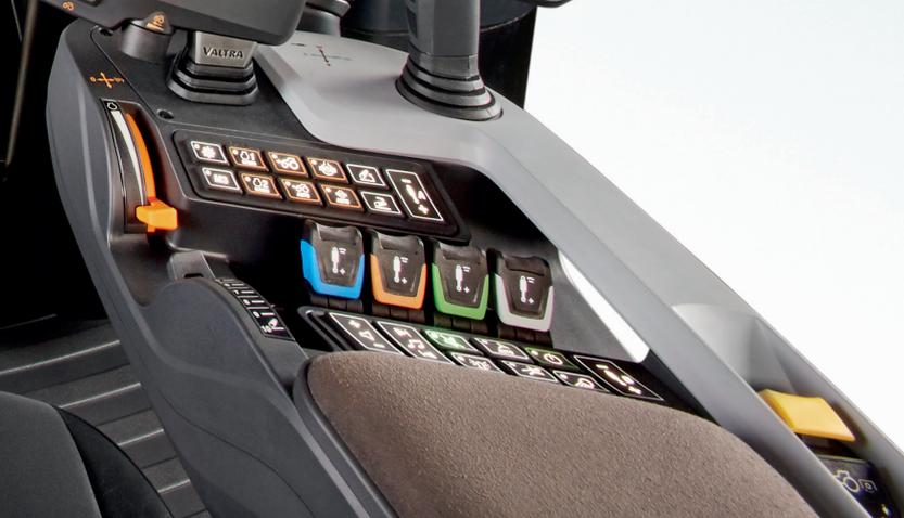
Кабина оснащена системой четырехточечной пневматической амортизации Valtra AutoComfort, в которой применены самые современные технологии управления. Датчики передают информацию системе управления, которая следит за тем, чтобы кабина всегда находилась в правильном положении. AutoComfort также позволяет вам регулировать подвеску в соответствии с личными предпочтениями.
