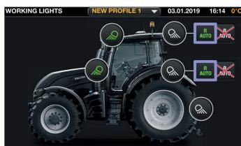
Рабочие фары также легко настроить с помощью 9-дюймового сенсорного экрана. Кроме того, в подлокотнике предусмотрены кнопки включения/выключения рабочих фар и проблескового маячка.
