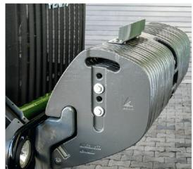
■ На передней части рамы можно закрепить противовес массой 990 кг.
