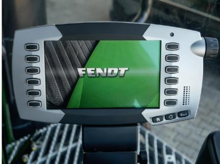
Для работы системы автоматического вождения и вывода большого количества информации в кабине может быть установлен дополнительный дисплей C3000.
