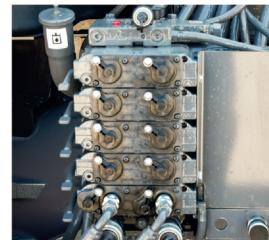
■ Шесть гидрораспределителей, штуцер сливной линии и штуцер функции PowerBeyond находятся в задней части трактора.
