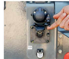
□ Внешние потребители можно подключить к розетке электропитания напряжением 12 В в задней части трактора. Соединение трактора с системами рабочего оборудования осуществляется через разъем ISOBUS.
