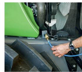
□ Для очистки радиатора в передней части трактора предусмотрели штуцер пневматической системы.
