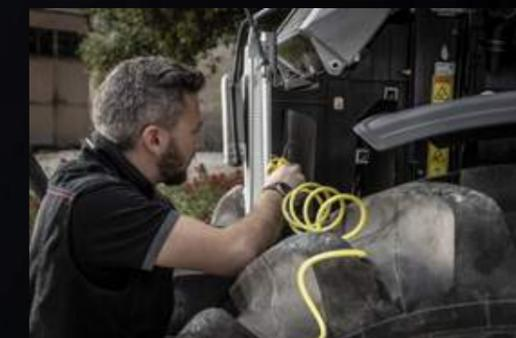
Система охлаждения отличается простотой доступа, очистки и обслуживания.
