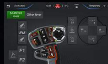
**Назначение переключателей рычага MultiPad для управления через ISOBUS:** навесным оборудованием с поддержкой протокола ISOBUS можно управлять непосредственно с помощью рычага MultiPad. Размещение всех органов управления (трактора и орудия) на одном рычаге гораздо удобнее по сравнению с использованием дополнительных дисплеев и рычагов.
