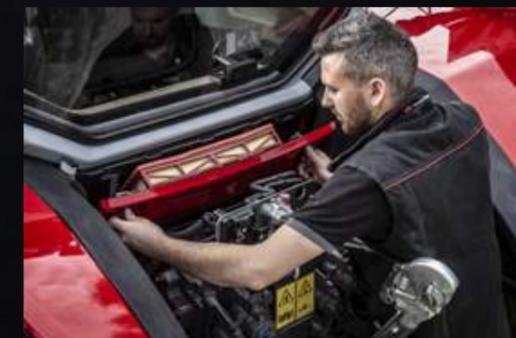
Воздушный фильтр внутри кабины легко снимается для очистки.
