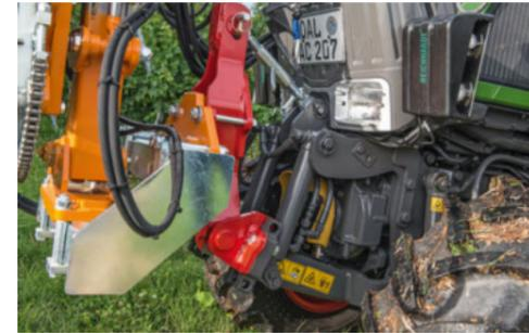
Нижние тяги переднего гидравлического оборудования можно сложить за несколько действий, чтобы обеспечить компактность размеров.
