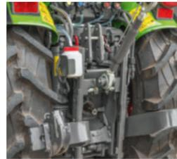
□ Пневматическая тормозная система с двумя контурами имеет встроенную конструкцию.
