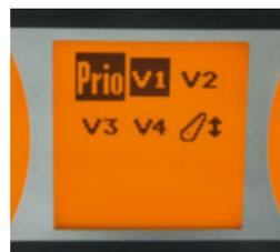
■ Функция приоритета позволяет выбрать наиболее нужного потребителя гидравлической мощности.
