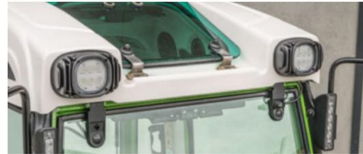
Яркие светодиодные фонари рабочего освещения в передней секции крыши обеспечивают освещение на большое расстояние.
