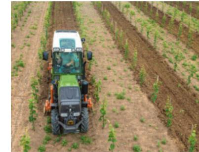
Вытянутая конструкция с узкой центральной частью обеспечивает широкий угол поворота (до 58°) и непревзойденную маневренность при использовании системы рулевого управления VarioActive.
