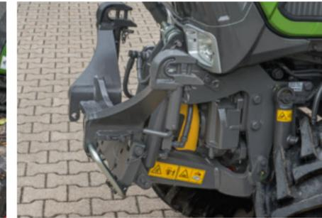
Передний механизм навески в комплектации Р имеет грузоподъемность 2540 даН.
