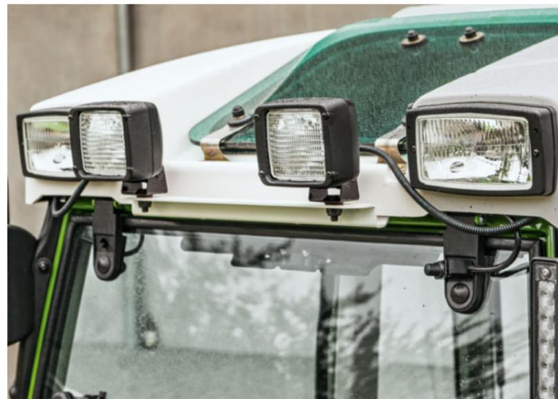
В передней части трактора с дополнительными фарами также можно установить два дополнительных фонаря рабочего освещения.
