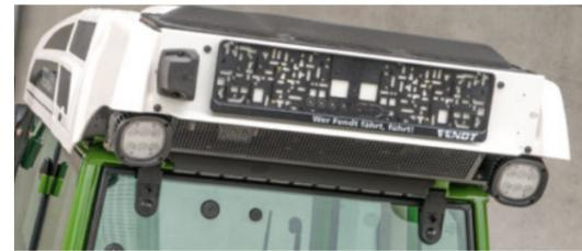
Светодиодные фонари рабочего освещения в задней части крыши позволяют видеть рабочее оборудование позади трактора.
