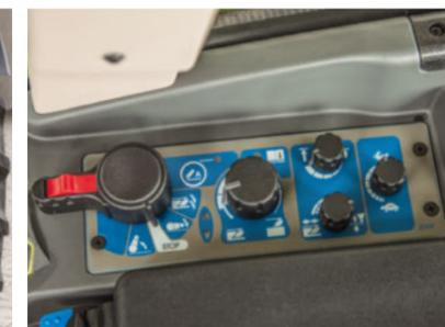
Регулировка заднего механизма навески удобно выполняется с помощью панели управления электрогидравлическим механизмом навески. Также данную функцию можно назначить на кнопку многофункционального джойстика.
