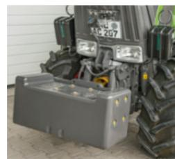
Груз в передней части улучшает работу трансмиссии на переднем мосту.
