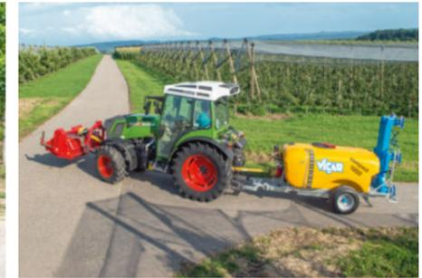
Работа ВОМ не зависит от скорости движения трактора. Например, можно двигаться с небольшой скоростью при измельчении густой нескошенной культуры, а затем плавно увеличить скорость без переключения передач, если культура станет более редкой.
