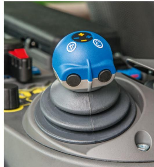
■ 3-й и 4-й контуры управления удобно включаются с помощью кнопки или переключателя на электрическом рычаге крестообразного хода.
