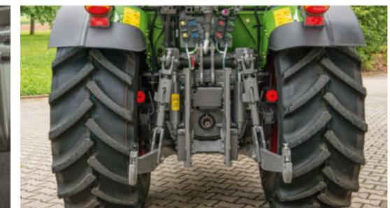
В комплектации P доступен полнофункциональный механизм навески категории 2. Все соединения удобно расположены и легко доступны во всех комплектациях.
