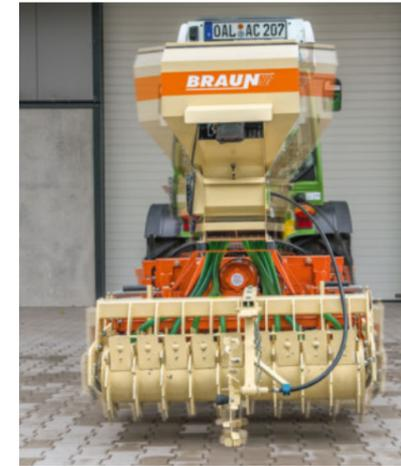
Нижние тяги можно регулировать влево и вправо с помощью двух гидроцилиндров, чтобы обеспечить точное положение заднего рабочего оборудования относительно ряда. Также имеется плавающее положение, в котором оборудование копирует неровности грунта.
