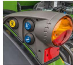
■ На задних крыльях расположены наружные органы управления гидросистемой и ВОМ.
