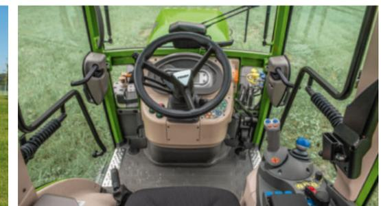
Большая площадь остекления и узкая рулевая колонка обеспечивают превосходный обзор рабочего оборудования в любых ситуациях. Окно в крыше гарантирует полный контроль при выполнении работ с поднятым оборудованием, например, на хмелевых полях.
