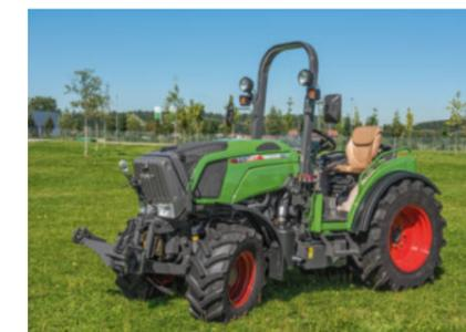
Для работы в теплицах или в ограниченном пространстве компания Fendt предлагает тракторы без крыши и с дугой защиты при опрокидывании.
