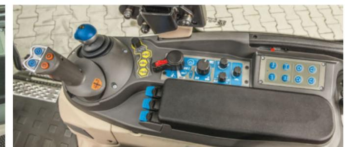
Кнопки на удобном многофункциональном джойстике обеспечивают всеми функциями: задний механизм навески, гидрораспределители, круиз-контроль и сохраненные настройки скорости. Подлокотник можно сложить, чтобы обеспечить доступ к поворотному регулятору, который позволяет настроить функции кнопок на джойстике.
