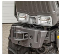
При отсутствии переднего механизма навески можно закрепить дополнительные балластные грузы непосредственно на раме.
