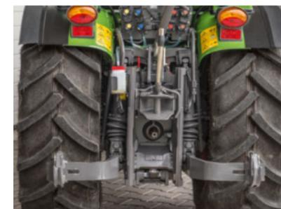
Поворотный механизм навески в комплектациях V/F крепится к передней части заднего моста. Регулируемые по ширине нижние тяги и крюки обеспечивают простую регулировку под любое рабочее оборудование.
