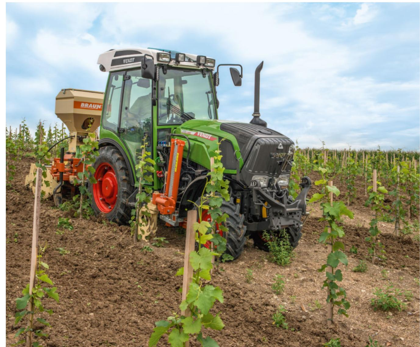
Защита грунта обеспечивается комбинацией нескольких решений: поворотные механизмы навески с точкой тяги в передней части, полный привод и автоматическая блокировка дифференциала, блок выравнивания и контроль крена на переднем мосту. Оптимальное тяговое усилие в любых условиях.
