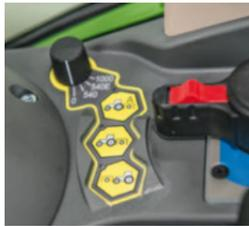
■ Нужная частота вращения ВОМ удобно выбирается с помощью поворотного регулятора.
