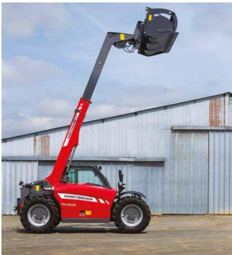
Для более плавной работы MF TH.6030 оснащается системой демпфирования крайних положений стрелы.
