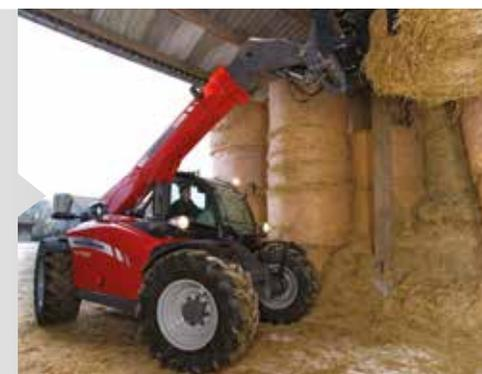
Два варианта расположения кабины по высоте для расширения диапазона применения машины. Низкопрофильный вариант отлично подходит для работы в помещениях с низкими проемами ворот. Расположение кабины не влияет на обзорность и маневренность.
