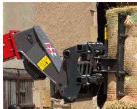
На конце стрелы установлен блок с быстроразъемными муфтами для удобного подключения гидравлических функций навесного оборудования.
