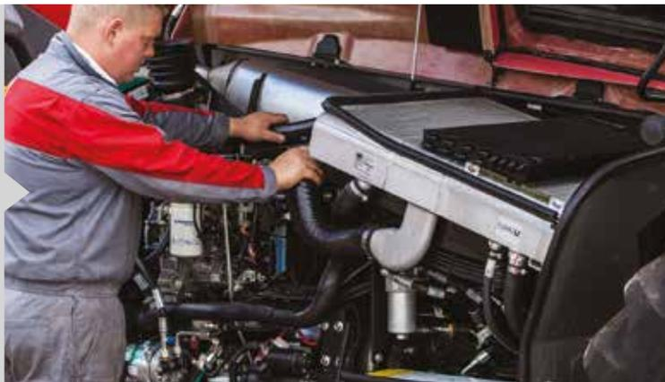
Воздушный фильтр легко снимается для проверки и очистки. Автоматический реверс вентилятора доступен опционально (в базе на MF TN.7038) – просто нажмите кнопку или установите автоматическую активацию и вентилятор будет реверсироваться, выдувая пыль и другие частицы, скапливающиеся в радиаторах.
