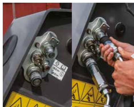
Подключение гидравлических функций осуществляется легко благодаря системе декомпрессии. Для более насыщенных орудий, таких как измельчитель соломы и ковши-раздатчики, возможна опциональная установка электрической линии (4-я и 5-я функции).
